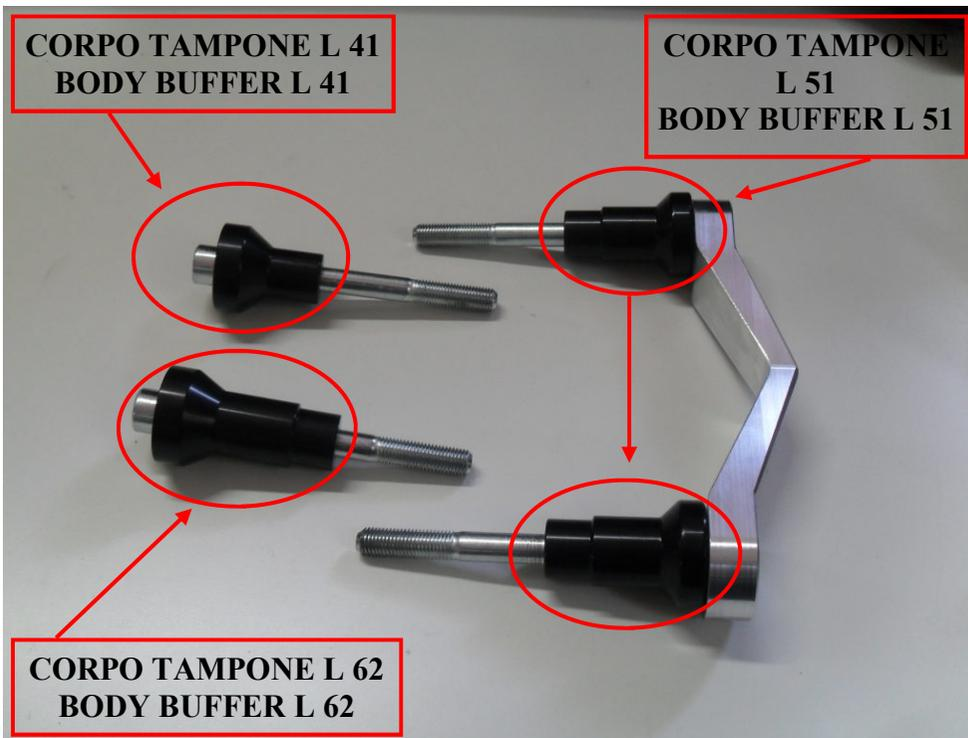
Per poter montare il tampone su staffa 4Racing, svitare i perni motore 1 per volta e avvitare il tampone su staffa.
